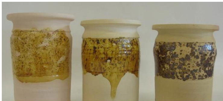
Fig. 2. Mélange limaille de plomb, farine, et 2% d'oxyde de fer broyé. Essais réalisés sur 3 exemplaires, l'un à gauche en cuisson électrique à 900 °, le second au centre en cuisson bois placé à l'arrière du four, le troisième à droite en cuisson bois placé à l'avant du four (proche du foyer).
