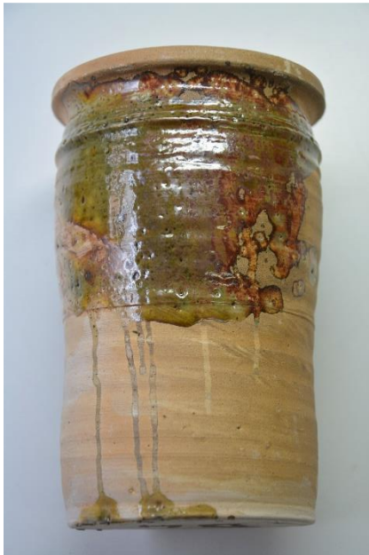
Fig.5. Le mélange précédent après cuisson, dans une atmosphère un peu réductrice.
