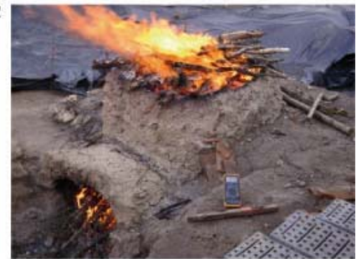
Alimentation en branchage (1) puis en bûches (2) directement dans le laboratoire
